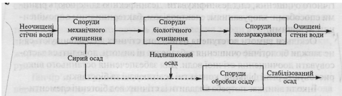
Рис. 5.1. Блок-схема очищення міських стічних вод
