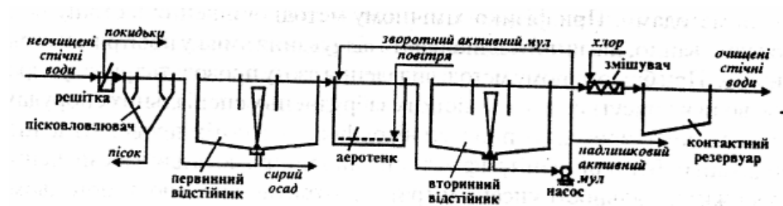
Рис. 5.2. Типова технологічна схема очищення міських стічних вод
