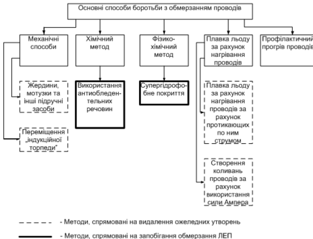
Рис. 2. Основні методи боротьби з обмерзанням проводів
