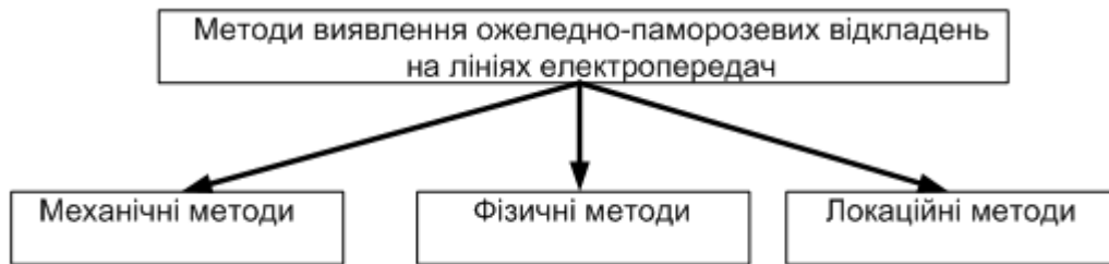
Рис. 1. Методи виявлення ожеледно-паморозевих відкладень на лініях електропередач
