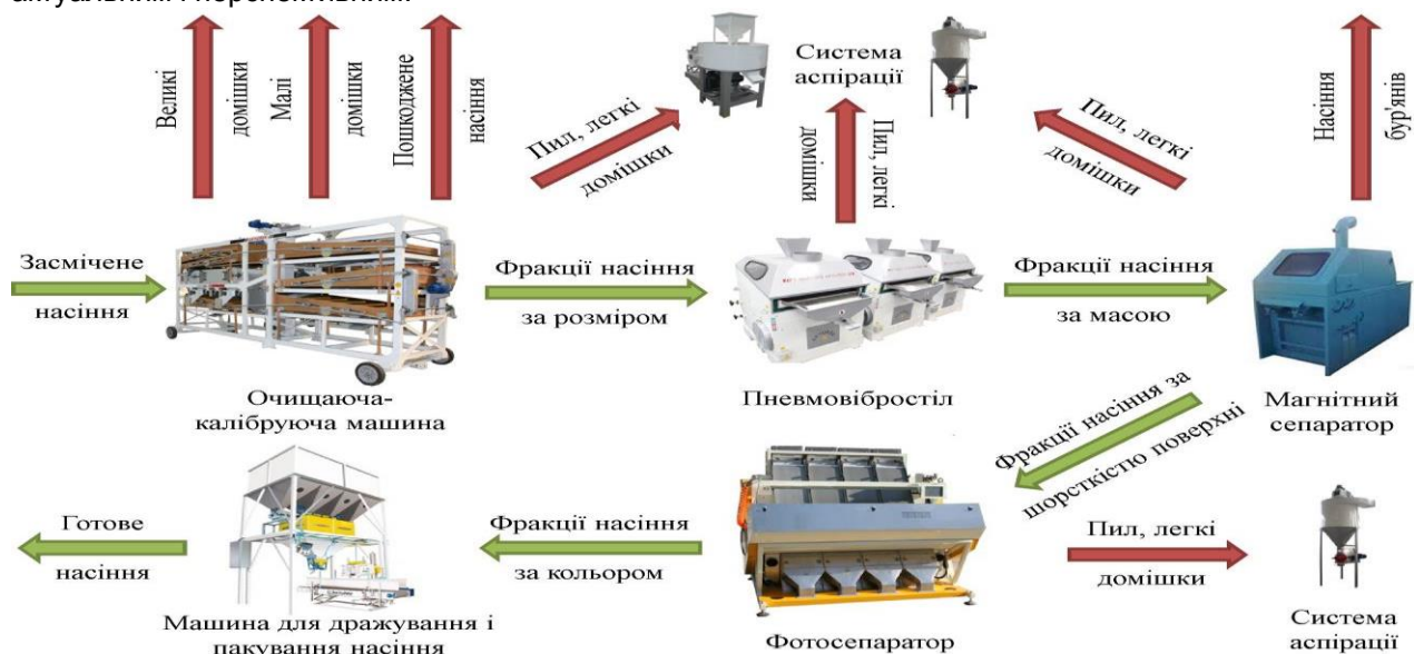
Рис. 1. Сучасна технологічна лінія процесів очищення, розділення та сепарації насіннєвого матеріалу олійних культур.
