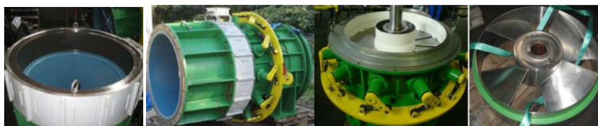
Рис. 8. Елементи експериментального гідрокомплексу на 75 кВт: а) направляючі лопаті; б) ротор з інтегрованою пропелерною турбіною; в) статор СГПМ та г) експериментальний гідрокомплекс на 75 кВт
