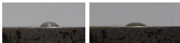
Рис. 7. Капля розчину на образці із сталі після традиційного шліфування 1 і 5 секунд
