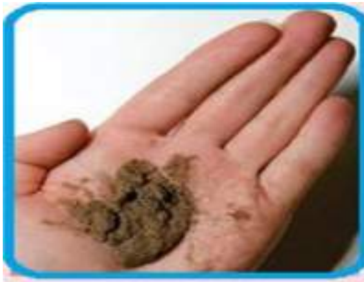
шнур при розкочуванні нестійко формується і руйнується при подальшому скочуванні – грунт піщаний
