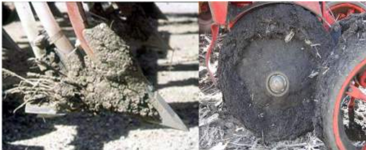
Рис. 8.12. Наліпання ґрунту на робочі органи ґрунтообробної техніки
