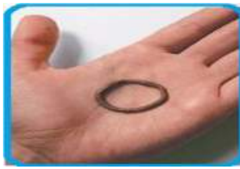
шнур утворюється і згортається в кільце без тріщин – грунт глинистий
