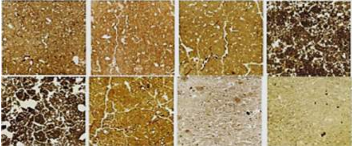
Рис. 4.5. Характер складення ґрунту у системі 3D сканування для різних горизонтів профілю ґрунту (пори і тріщини мають білий колір).
