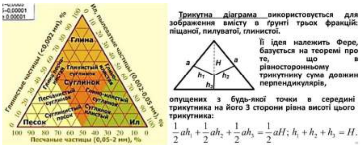
Рис. 5.5. Трикутник Ферє для діаграмного визначення співвідношення гранулометричних фракцій ґрунту (верхня позиція в оригінальному методично-мовному представленні).
