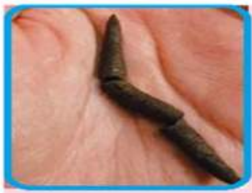
шнур при розкочуванні утворюється, але розпадається на частини – грунт легкосуглинковий
