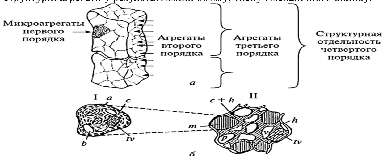
Рис. 5.32. Будова призматичної структурності агрегатів, що показує агрегованість різних порядків (по Б.Г. Розанову) (а); схема складені структури (по Ф. Дюшофуру) (б) (мовою оригіналу):
