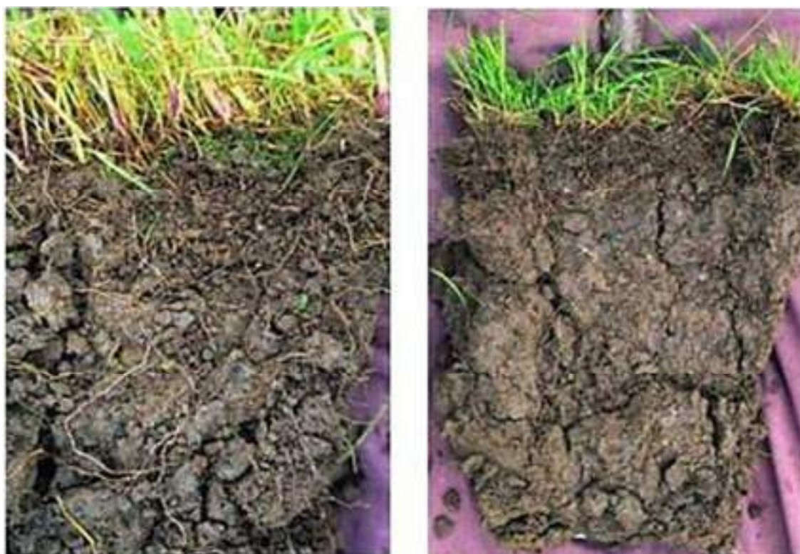
Рис. 5.50. Структура ґрунтів: зліва виражена, справа – невиражена.
