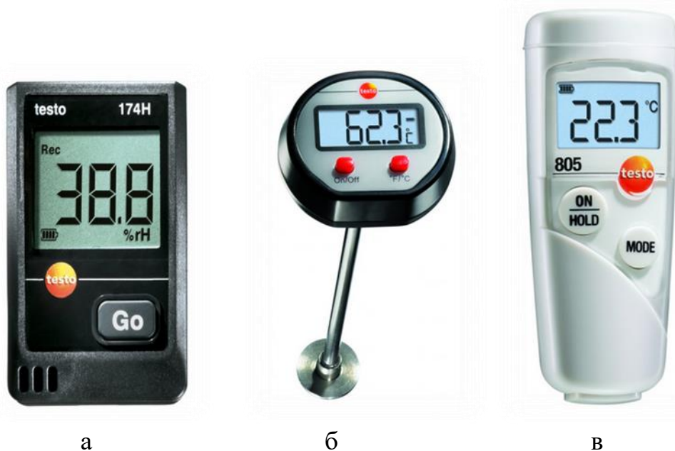
Рис. 13.7. Електронні прилади для вимірювання параметрів мікроклімату: а – Testo 174 Н; б – Testo 1109; в – Testo 805.
