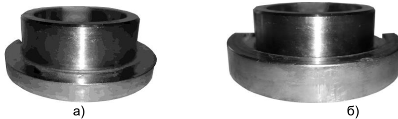
Рис. 7. Напівфабрикат заготовки штампування обкочуванням деталі типу зубчасте колесо а) напівфабрикат 1-го проходу; б) напівфабрикат 2-го проходу (готовий фланець).
