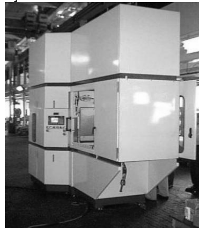
Рис. 6. Турбоабразивная установка модели TF-522 [14]
