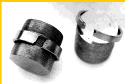
Кільцеві зразки, зруйновані роздачею на деформуються оправках
