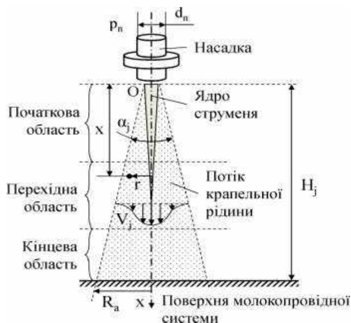
Рис. 1 – Схема зміни структури струменя миючого розчину з віддаленням від сопла
