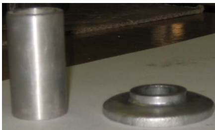
Рис. 2. Заготовка до и после выдавливания
