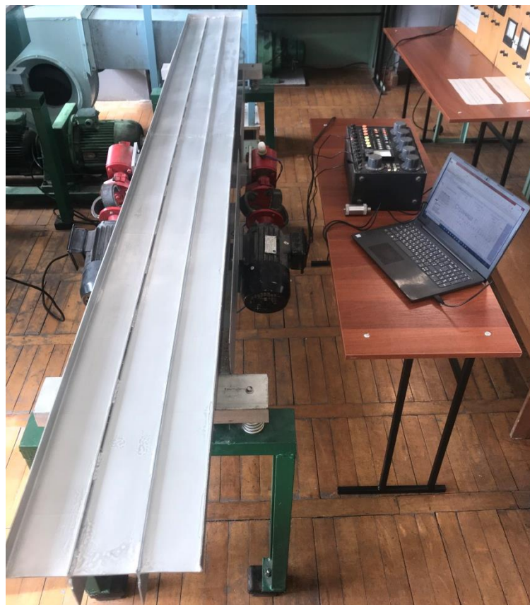
Рис. 3. Загальний вигляд вібрототка із вимірювальним обладнанням
