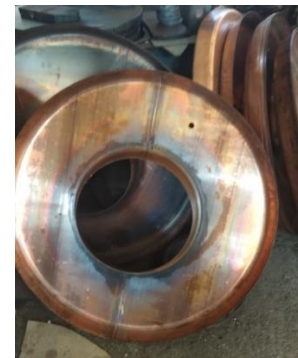
Рис. 8. Вироби, отримані ротаційним відбортуванням методом ШО
