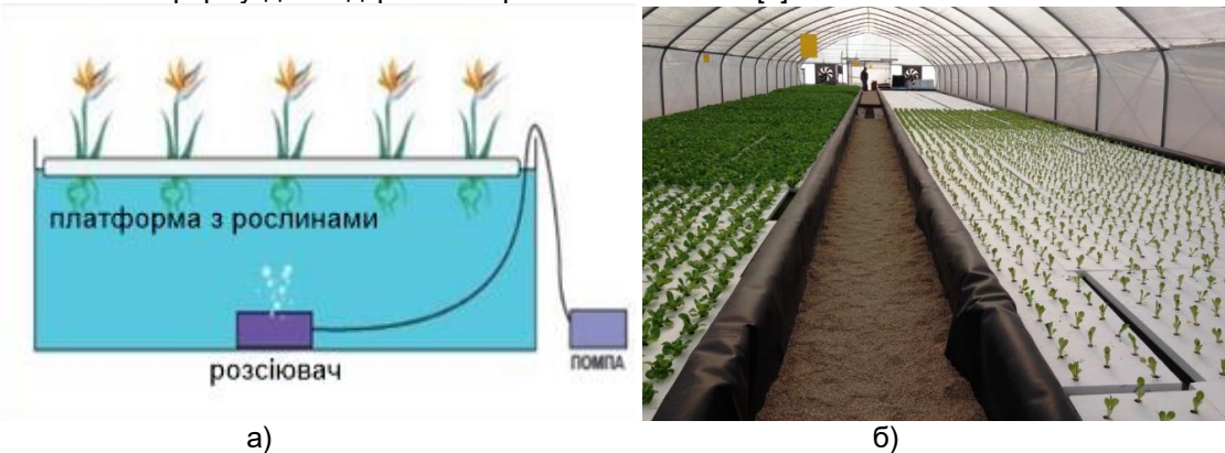
Рис. 2. Схема та приклад застосування гідропонної установки Water Culture
