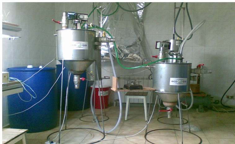
Рис. 2. Науково-дослідна установка анаеробного зброджування органічних відходів
