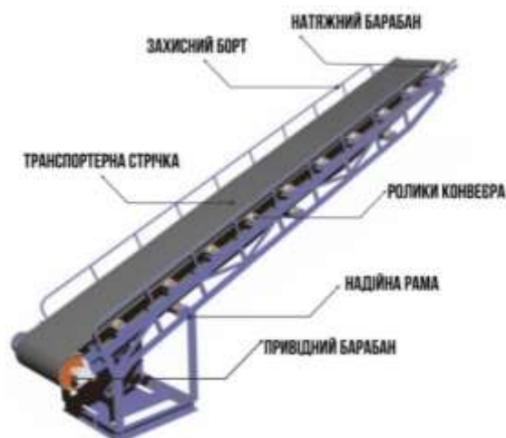
Рисунок 2.1. – Прямий стрічковий конвеєр
