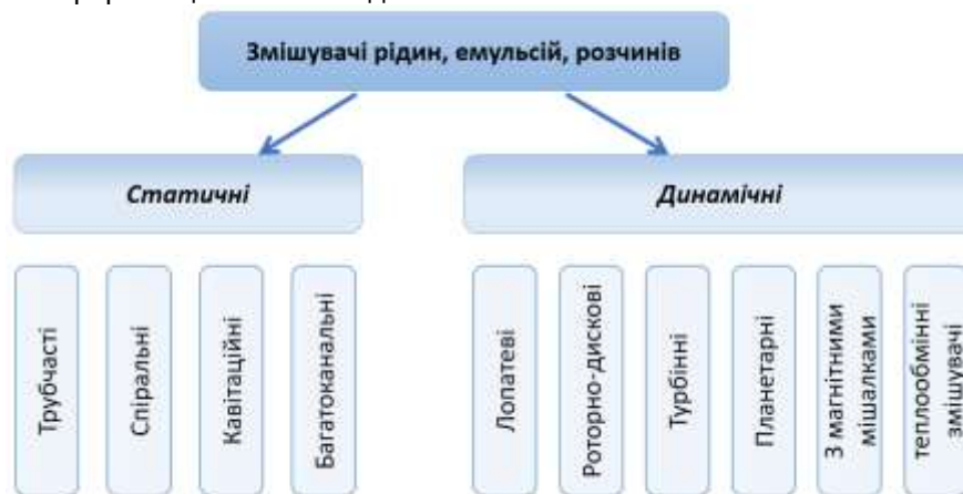
Рис. 3. Класифікація змішувачів рідин, емульсій, розчинів та рідких сумішей
