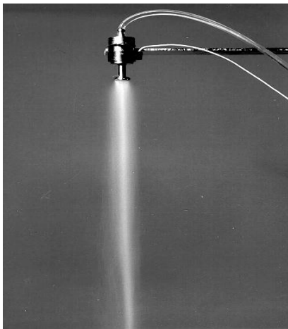
Рис. 4. Вузький щільний факел аерозолі при ультразвуковому розпиленні
