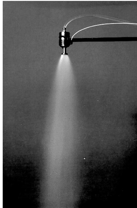
Рис. 5. Розширений факел аерозолі при ультразвуковому розпиленні
